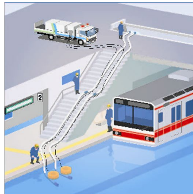
5m 3 Type ( \phi 200 \times 5\text{m}^3/\text{min} \times 10\text{m} \times 12\text{kW} )
